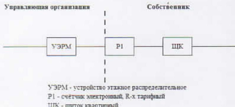
Исполнитель несет ответственность за надлежащее состояние и работоспособность питающих электрических сетей на квартиру согласно вышеуказанной схеме до прибора учета (пунктирной линии слева).
